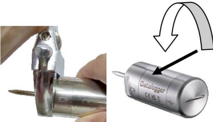
3. Retire la batería y la junta tórica antiguas, luego instale la nueva batería y la junta tórica. Asegúrese de que la batería esté orientada correctamente según las marcas de polaridad.
