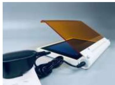
3. Coloque el gel que se va a observar en el área visible de la superficie de trabajo.
