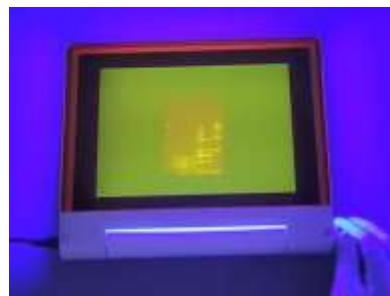
8. Si las bandas no se ven claramente debido a la iluminación ambiental o si es necesario conservar la información de los resultados, puede utilizar una minicámara oscura para la observación o emplear un teléfono móvil para tomar fotografías.
